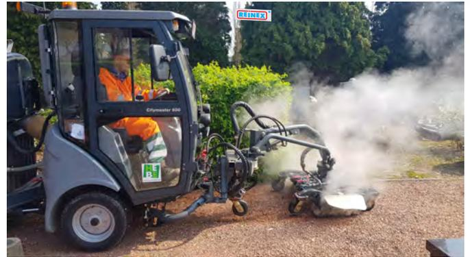
Auslegearm Arbeitsbreite max. 1000 mm
